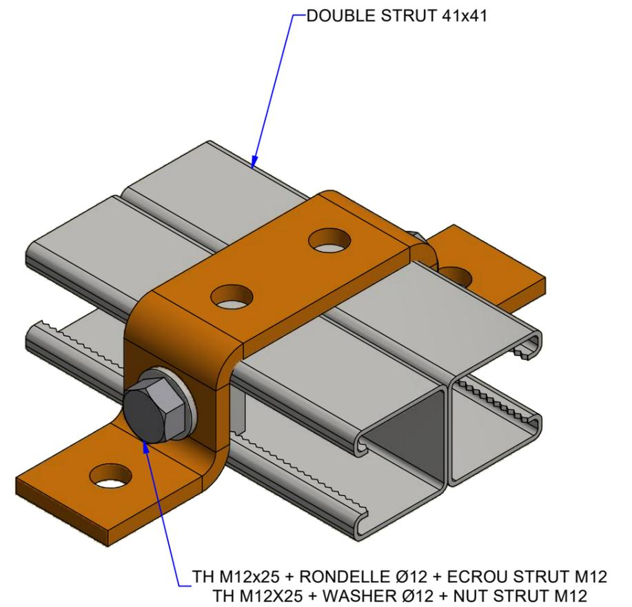
I3 : Tôle d'acier inoxydable suivant NF EN 10088-2 (316L).
